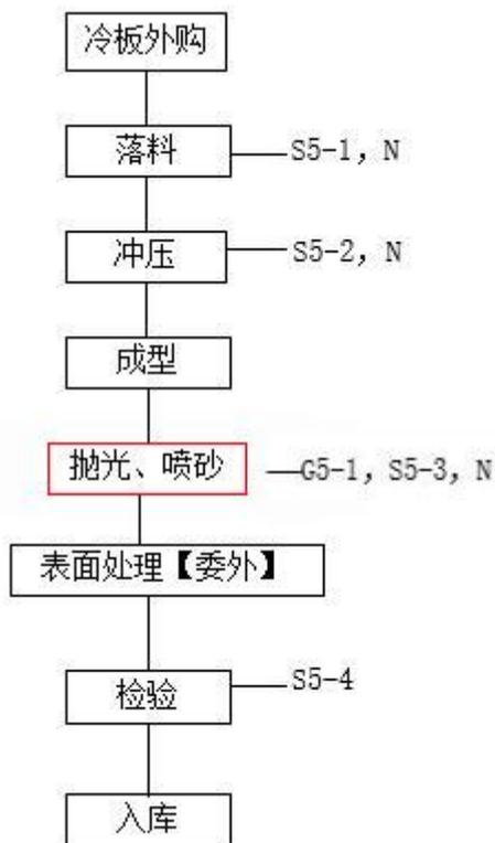
图 2-7 冲压件工艺流程图
