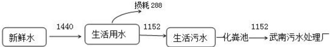
图 2-1 环评水平衡图 (t/a)
